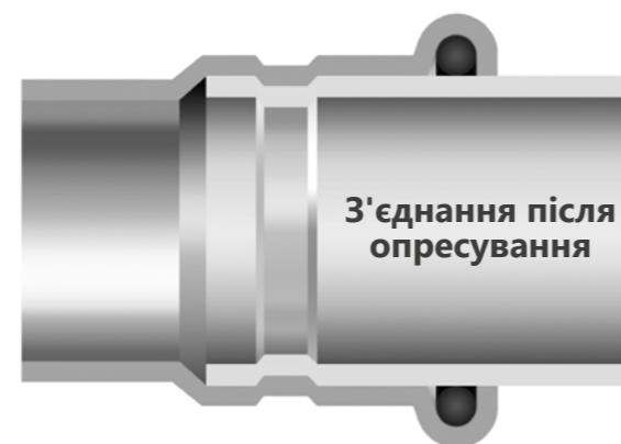
З'єднання елементів у технології "Press" дає змогу отримати з'єднання з мінімальним звуженням перерізу труби, що істотно знижує втрати тиску в усій системі та позитивно впливає на гідралічні характеристики. Герметичність і надійність з'єднань у системі KAN-therm Steel забезпечують спеціальні ущільнювачі типу O-Ring і чотирьохточкова система обтиску типу "M".
