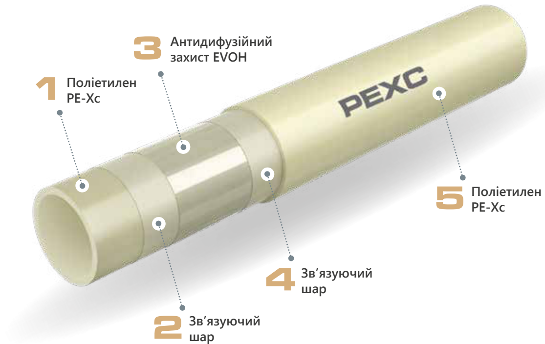
Конструкція труби PEXC з антидифузійним шаром
