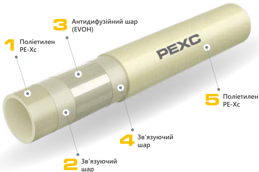
Конструкція труби PE-XC з шаром EVOH
