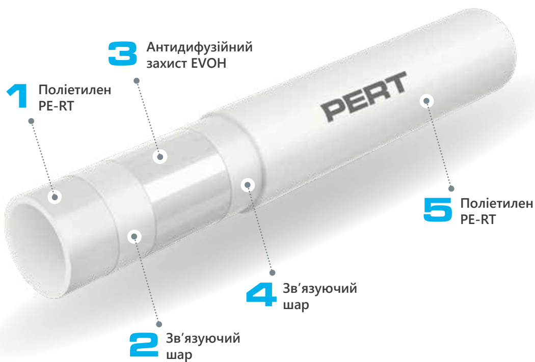
Конструкція труби PERT з шаром EVOH
