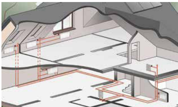
Вертикальне розведення в системі опалення
