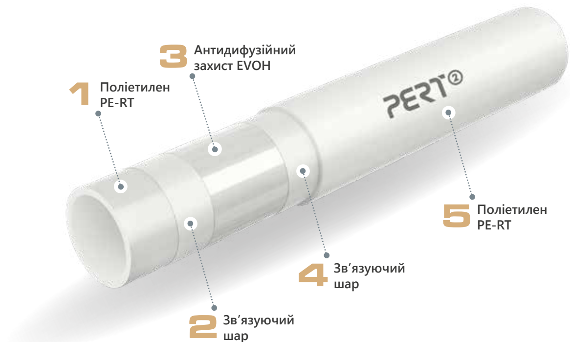
Конструкція труби PERT 2 з антидифузійним шаром
