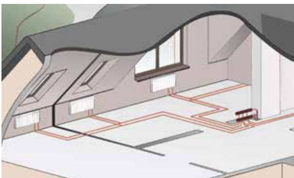
Колекторне розведення з трійниками в системі опалення.
