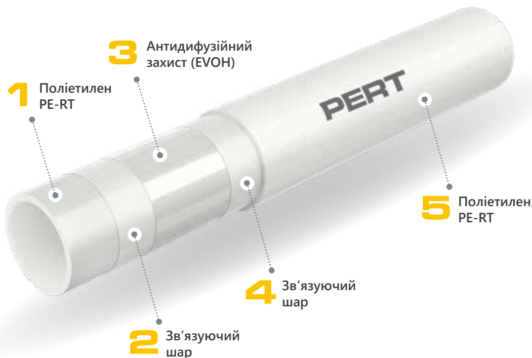
Конструкція труби PERT з шаром EVOH
