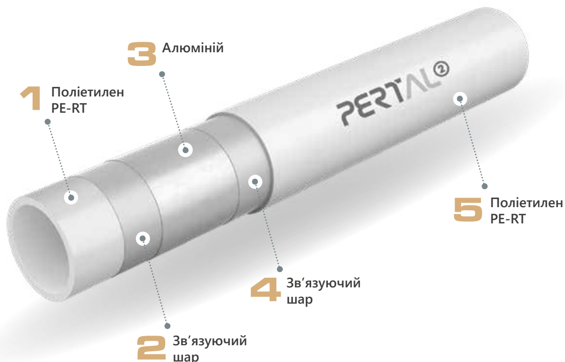
Конструкція труби PERTAL 2
