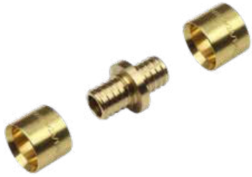
Рис. 47. Двосторонній з'єднувач KAN-therm Push для труб PEXC, PERT і bluePERT діаметрами 12×2; 14×2; 18×2; 18×2,5; 25×3,5
