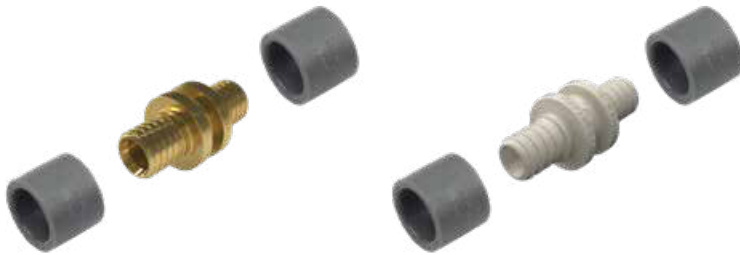
Рис. 48. З'єднувач KAN-therm ultraLINE для труб PEXC, PERT 2 та PERTAL 2 діаметром 14×2; 16×2,2; 20×2,8; 25×2,5.
