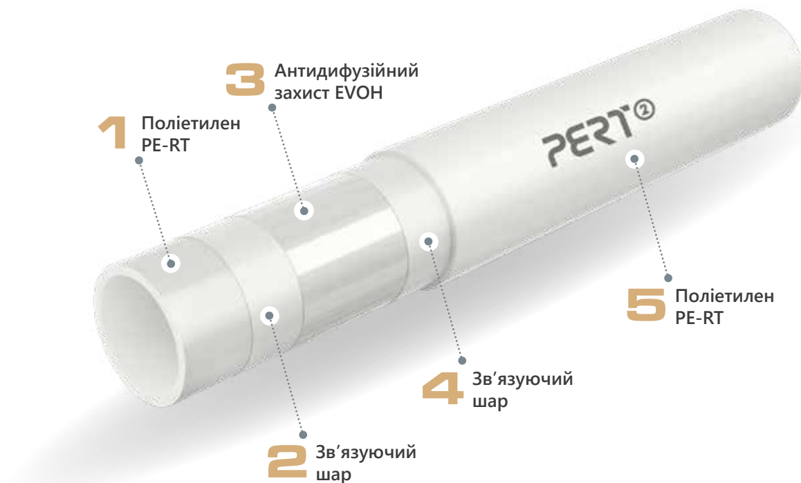
Конструкція труби PERT 2 з антидифузійним шаром
