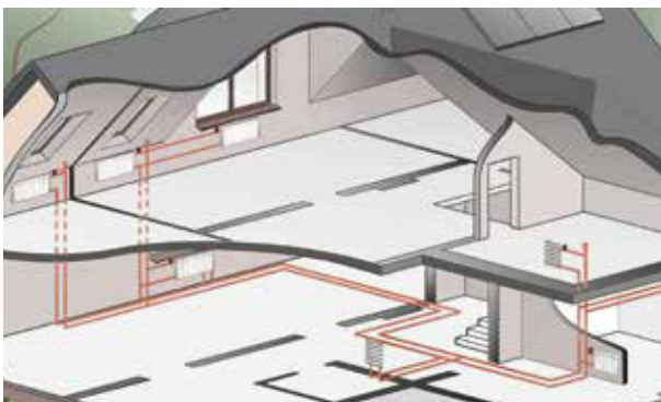
Вертикальне розведення в системі опалення
