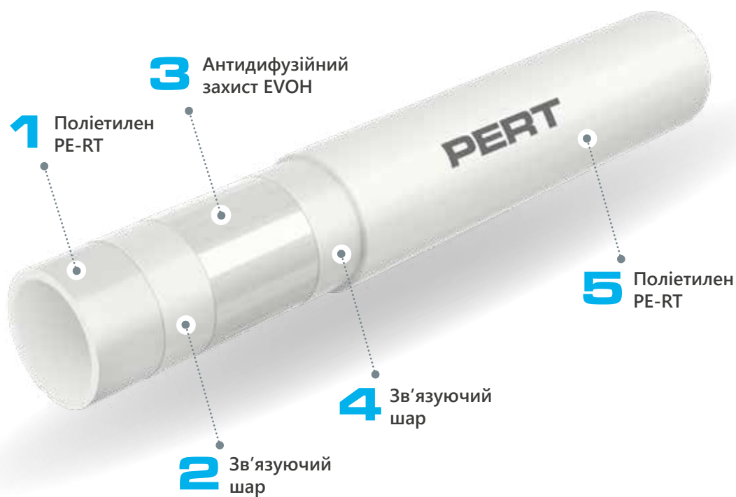
Конструкція труби PERT з шаром EVOH
