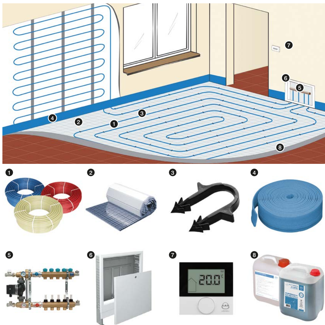
Рис. 40. Элементы панельного отопления/охлаждения KAN-therm
