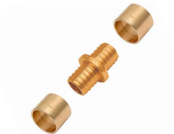
Рис. 43. Двухсторонний соединитель KAN-therm Push для труб PE-Xc и PE-RT диаметрами 12 × 2; 14 × 2; 18 × 2; 18 × 2,5; 25 × 3,5
