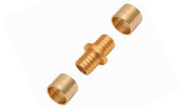
Рис. 43. Двухсторонний соединитель KAN-therm Push для труб PE-Xc и PE-RT диаметрами 12 × 2; 14 × 2; 18 × 2; 18 × 2,5; 25 × 3,5
